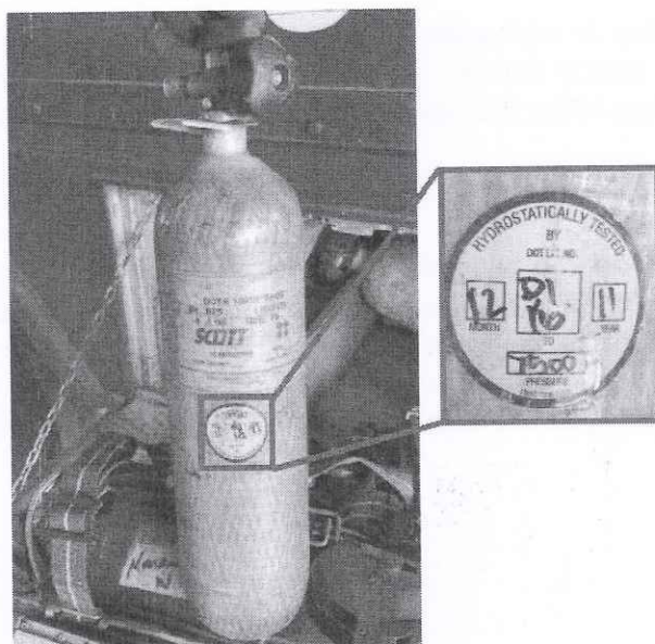
Fig 2. Etiqueta de Prueba Hidrostática del cilindro de equipo de respiración autónoma marca SCOTT, 4500 psi, 30 minutos, perteneciente a la U-28
