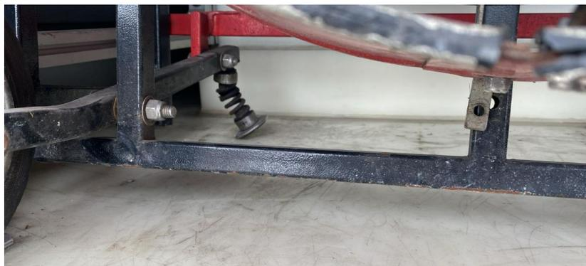
**Figura 2.** En la imagen se muestra el ventilador de presión positiva marca WindFire correspondiente a la unidad U-48, el cual presenta una pata deformada. Tomando en
