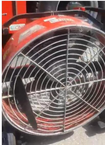
**Figura1.** En la imagen se muestra el ventilador de presión positiva marca WindFire correspondiente a la unidad T-73, el cual presenta un aspa rota.
